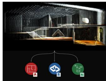
Attraverso i rilievi con il Laser Scanner acquisiamo un modello tridimensionale, navigabile ed interrogabile completo e accurato, che dopo la ricostruzione della **nuvola 3D**, viene riportato in ambiente **CAD e BIM** (Building Information Modelling) per eseguire tutti i tipi di visualizzazione, misurazione, progettazione, modellazione e manutenzione dell'esistente.
